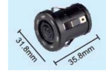
Öffnungswinkel:150° diagonalBetriebstemperatur:- 30°C bis +85°CLagertemperatur:- 40°C bis +105°CMaße Außengehäuse:Ø 31,8mm (Bohrloch 25mm) , L~ 35,8mm , 50gAnschluss:6-Pin-Mini-DIN Stecker ohne Verschraubung Ø 12.3 mmSchutzklasse:IP68 + salzbeständiges Gehäuse, Powerbox = IP67Schockgeprüft8G
